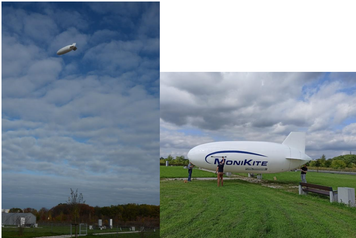
Aerostat MoniKite-105 a) na wysokości operacyjnej ok. 50 m nad ziemią, b) na ziemi
